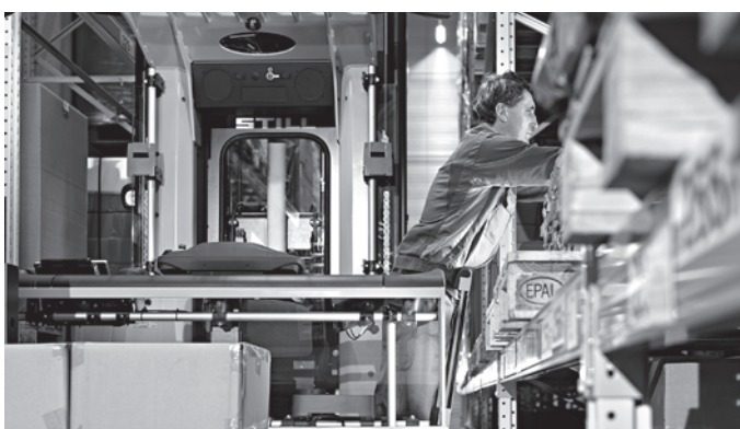
Наклонное ограждение для эргономичного комплектования до края поддона
