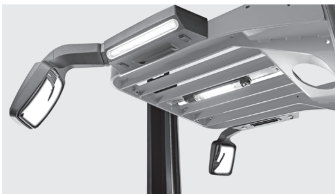
Индивидуально регулируемое зеркало заднего вида для легкого заезда в узкий проход
